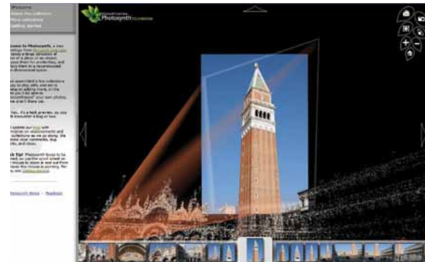
Figuur 3 • Photosynth. Uit vele foto's die uit verschillende hoeken zijn genomen wordt een driedimensionale weergave gemaakt van een gebouw of object.
